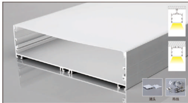
PG08X 产品参数 20040 尺寸: Lx200x40mm 表面: 氧化铝本色/喷漆 (黑色/白色) PC罩: 乳白/黑色/亚克力磨砂可选 适用: 175MM软灯带/硬灯条
