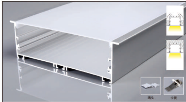
PG15X 产品参数 15040带边 尺寸: Lx166x40mm 表面: 氧化铝本色/喷漆 (黑色/白色) PC罩: 乳白/黑色/亚克力磨砂可选 适用: 125MM软灯带/硬灯条
