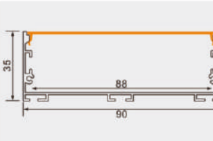
PG157X 产品参数 9035 尺寸: Lx100x35mm 表面: 氧化铝本色/喷漆 (黑色/白色) PC罩: 乳白 适用: 92MM软灯带/硬灯条
