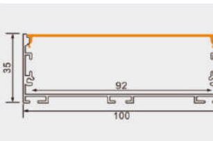
PG56X 产品参数 10035 尺寸: Lx100x35mm 表面: 氧化铝本色/喷漆 (黑色/白色) PC罩: 乳白 适用: 92MM软灯带/硬灯条
