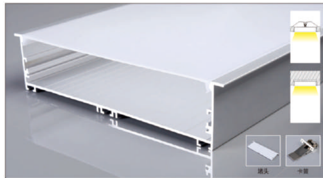
PG119X 产品参数 20050带边 尺寸: Lx216x50mm 表面: 氧化铝本色/喷漆 (黑色/白色) PC罩: 乳白 适用: 185MM软灯带/硬灯条
