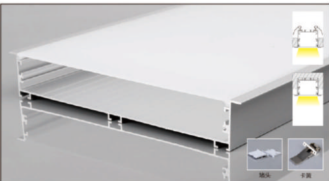
PR20035DBX 产品参数 20035带边 尺寸: Lx216x35mm 表面: 氧化铝本色/喷漆 (黑色/白色) PC罩: 乳白/黑色/亚克力磨砂可选 适用: 187MM软灯带/硬灯条
