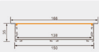
PR15035DBX 产品参数 15035带边 尺寸: Lx166x35mm 表面: 氧化铝本色/喷漆 (黑色/白色) PC罩: 乳白/黑色/亚克力磨砂可选 适用: 138MM软灯带/硬灯条
